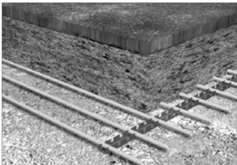
Рис. 2. Подогрев поверхности стадиона с травяным покрытием.
